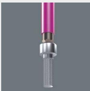
Le maintien de la vis à six pans creux dans est assuré par une bille élastique sur la partie longue de la clé mâle coudée. Particulièrement utile dans les espaces de travail d'accès difficile, où l'on ne peut pas se servir de l'autre main pour maintenir la vis.
