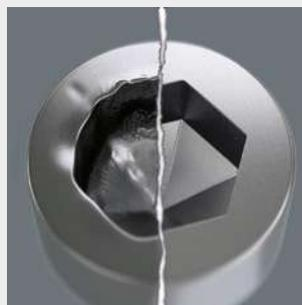
Le problème des vis à six pans creux tient à la minceur des surfaces d'appui sur lesquelles s'opère la transmission de la force depuis l'outil. Résultat : la tête de vis peut être endommagée. Les outils Hex-Plus possèdent des surfaces d'appui plus larges qui empêchent ce problème. Avec la possibilité, simultanément, de transmettre
