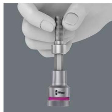
Les douilles et douilles à embout à fonction de retenue Zyklop maintiennent les vis sur l'outil en toute sécurité. Elles sont extrêmement utiles dans les espaces de travail d'accès difficile, où l'on ne peut pas se servir de l'autre main pour maintenir la vis.
